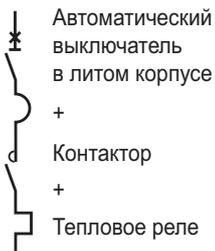
**Автоматический выключатель + контактор + тепловое реле**
